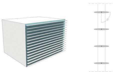
شکل ۸. هندسه سایه بان ثابت استفاده شده برای محاسبات
