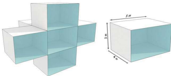
شکل ۷. هندسه منطقه و شرایط مرزی جداره‌ها با محیط بیرون
