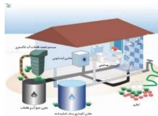
شکل ۴: ایجاد مرکز تصفیه در نزدیکی محل و استفاده از فاضلاب تصفیه شده برای آبیاری
