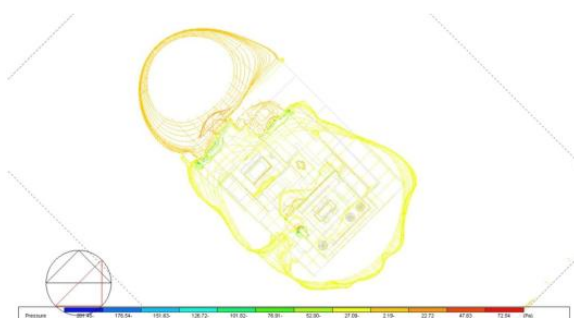
شکل ۷- شبیه‌سازی فشار موثر بر اثر باد در خانه گلشن (پلان)
